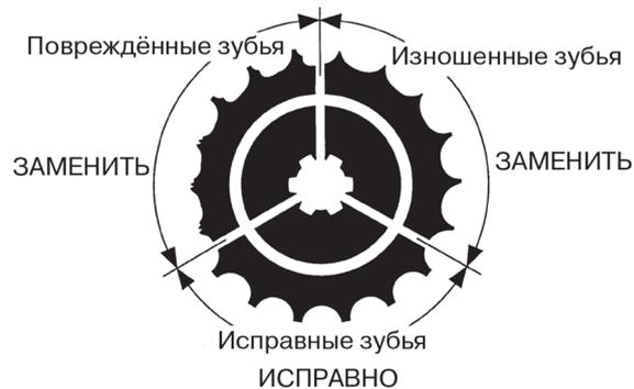
Рисунок 5.22. Вид зубьев звездочки.
