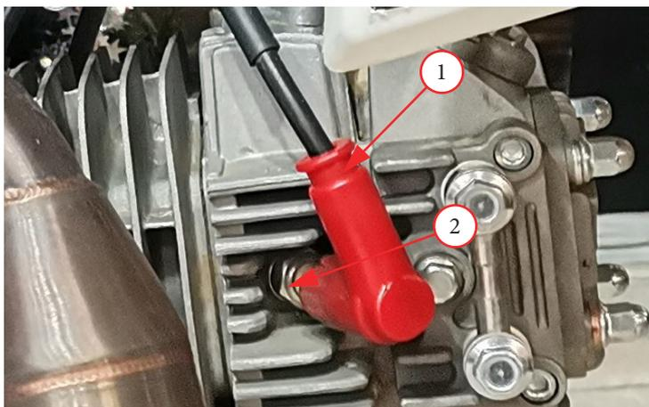
Фото 3.3. Свеча зажигания с колпачком: 1- колпачок; 2- свеча зажигания.
