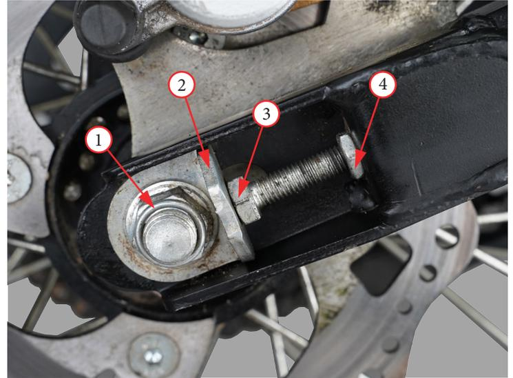
Фото 5.24. Регулировка натяжения цепи.
