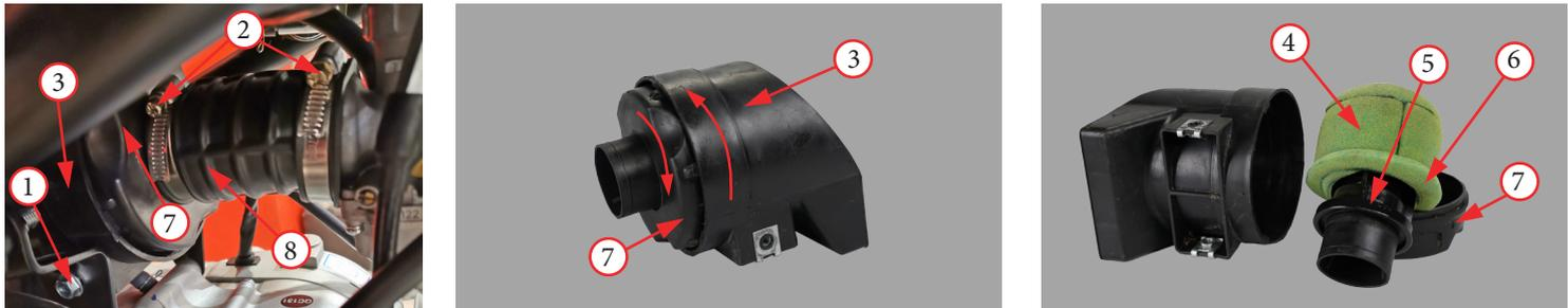
Фото 5.6. Снятие и разборка воздушного фильтра.
