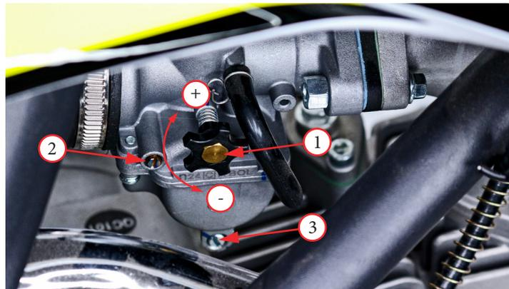
Фото 5.8. Регулировка холостых оборотов.
