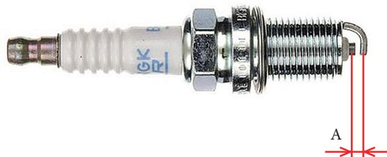
Фото 5.13. Зазор свечи зажигания.
