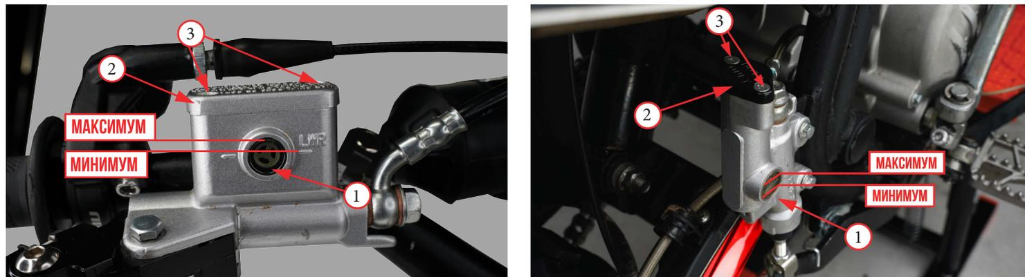
Фото 5.16. Контроль и долив тормозной жидкости.
