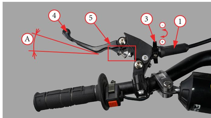
Фото 5.9. Регулировка свободного хода рычага сцепления (варианты исполнения).
