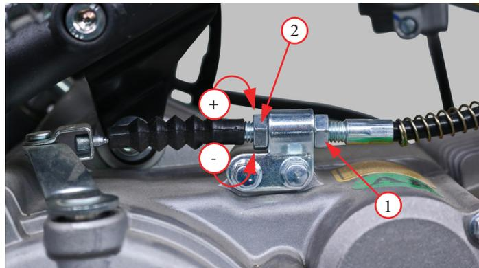
Фото 5.10. Регулировка сцепления на двигателе.
