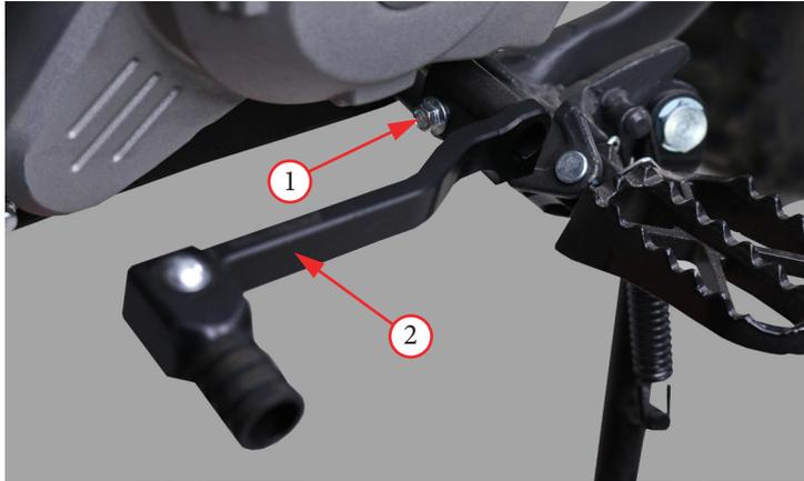
1. Рычаг переключения передач 2 (фото 5.11) должен быть надежно закреплен на валу.
