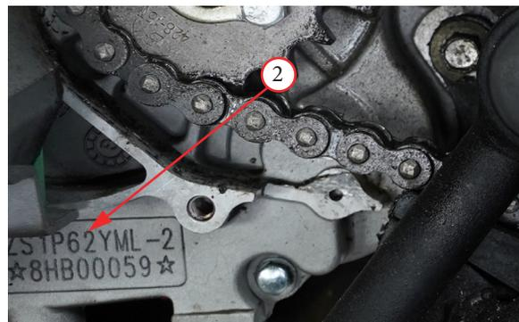
Фото 1.4. Место расположения серийного номера двигателя – 2.
